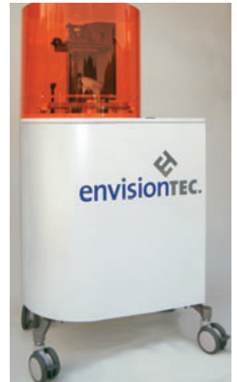
Abb. 2 Die CAM-Anlage (Digital Dental Printer) zur Belichtung des Komposits in feinen Ebenen.
